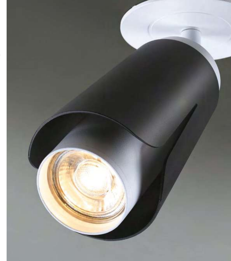
370830 IP 20 370831 Светильник встраиваемый Длина провода 2 м Алюминий GU10 max 9 Вт LED 220 В Врезное отверстие Ø 75 мм Высота встраиваемой части 27 мм
