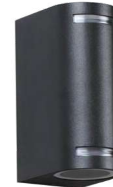
370839 IP 54 Светильник ландшафтный Корпус – алюминий/ рассеиватель – закаленное стекло GU10 max 2*15 Вт LED 220 В Диапазон раб. тем-р от -20° до +50° С
